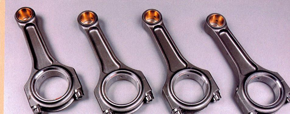
テックアートではJUNのコンロッドを使用している。コンロッドボルトはJUNのコンロッドには最初からARPが取り付けられているが、ノーマルを使用するならコンロッドボルトだけは強化品を使用したい。JUNのものにはコンロッドオイルジェットがなく、メタル部の油圧を確保出来るのも使っている理由の一つ
