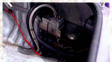
↑トランク内にはコレクタータンクとニスモ製の燃料ポンプを設置。横Gが掛かっても安定した燃料の供給が可能。
