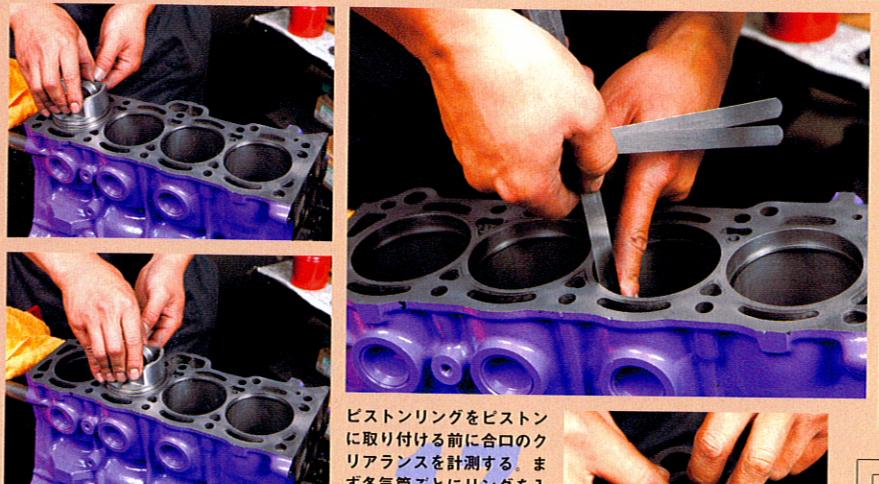
ピストンリングを取り付ける前に合口のクリアランスを計測する。まず各気筒ごとにリングを入れてダミーピストンを挿入して位置を均等&水平にする。合口をシックネスゲージで計測する
