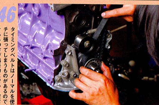
**46** タイミングベルトはノーマルを使用。強化ベルトは固いものが多く、暖まるとながれがちに張ってしまうものがあるので、ノーマルを短いスパンで換えることにしている。そちらの方が結果的に安いし確実だ
