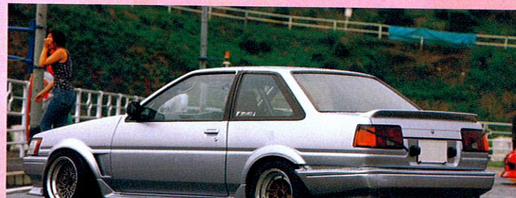
↑OSのシングルプレートのクラッチに、リアデフをTRDの4.7に変更。ランフリーのエアダクト付きFRP製フロントフェンダーなどにより機能的チューンコンセプトだ。
