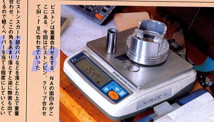
ピストンスカート部のバリなどを落とした上で重量合わせ。この角をあまり落とすと逆に弊害も出てきて軽くベーバーを当てる程度にしていくといい。重量合わせの基本は裏側だ
