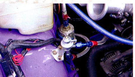
↑リアから送られてくる燃料は、この燃料フィルターとサードの調整式燃圧レギュレーター通り4ストロップで送られる。
