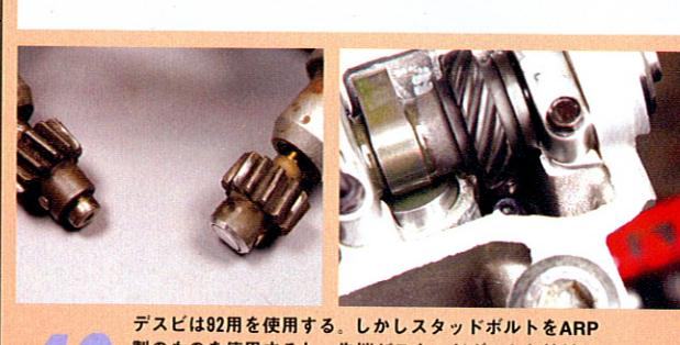
**40** デスピは92用を使用する。しかしスタッドboltをARP製のものを使用すると、先端がスタッドboltと接触してしまうので、写真のように先端をカット(グラインダーで削ってもいい)して接触を避ける。取り付けるとそのクリアランスが分かるだろう
