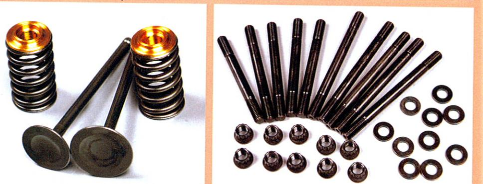
バルブはIN31.5ミリ、EX27ミリと各1、1.5ミリオーバーを使用。なのでシートリングの入れ替え無しで、シートカットのみで対応出来るのもうまみ。スプリングは自由長の稼げる楕円、リテナーは軽量チタンを使用。ヘッドボルトはARPを使う
