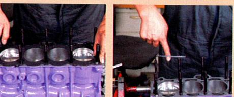
35 ヘッドは面研をしてからさらに砥石を細かくかけ、プロックも一度だけ修正面研をかけている。ヘッドガスケットはTRDの0.8ミリを使用、スタッドボルトにヘッドガスケットを入れていく
