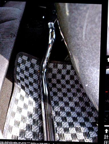
↑後部座席の足元部に装着したフロアバー。ボディ回りの補強はボルトオンパーツでおこなっている。
