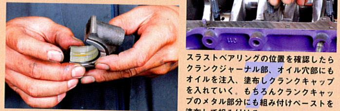
スラストベアリングの位置を確認したらクランクジャーナル部、オイル穴部にもオイルを注入、塗布しクランクキャップを入れていく。もちろんクランクキャップのメタル部分にも組み付けベーストを塗布して組み付ける
