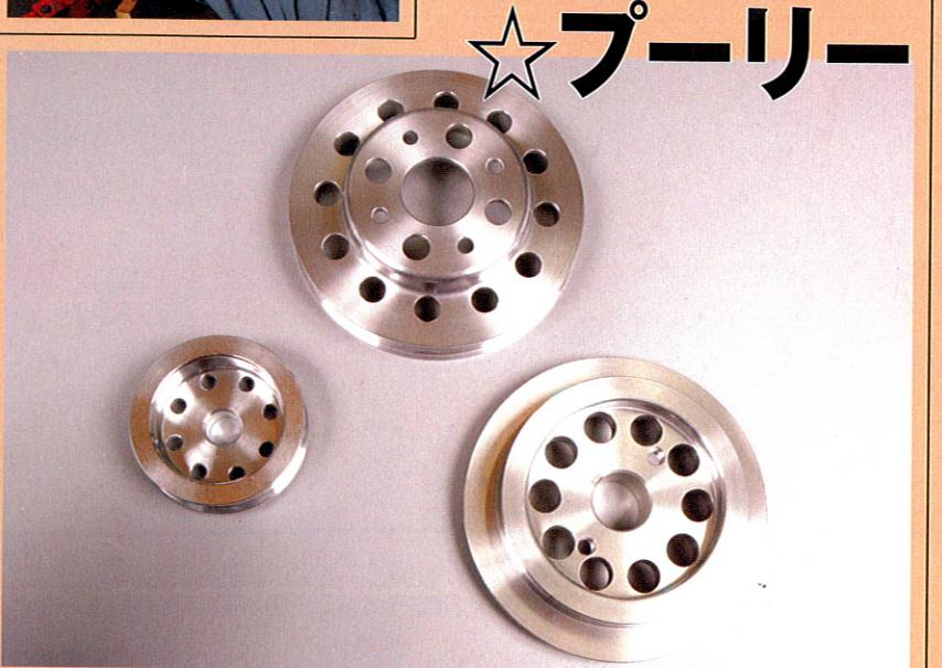
オリジナルアルミブーリー。純正ファンベルトで回せるタイプと、小径クランクブーリー(外径30%ダウン)、大径ウォーターボンブーリー(純正比20%ダウン)、大径オルタネータブーリー(20%ダウン)を使用
