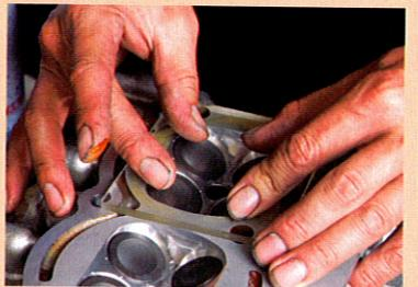
これも一応やり方を見せておこうが、実際はヘッドを組む前などに計測しておく。まずクリスを燃焼室の周りに塗りガラスを被せ注射器で燃焼室容積を計測。気筒ごとに合わせるのはもちろん。計測の結果、圧縮比は12.7になった。使用するヘッドガスケットは0.8ミリで装着時は0.7という計算から算出
