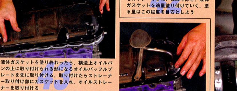
液体ガスケットを塗り終わったら、構造上オイルパンの上に取り付けられる形になるオイルバッフルフレートを先に取り付ける。取り付けたらストレーナー取り付け部にガスケットを入れ、オイルストレーナーを取り付ける
