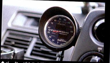
↑メーターパネルの横に装着しているのはVFCツインデジタルメーター。水温計を兼ねている。
