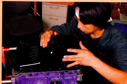
**44** ストレーナーを取り付けたらバッフルフレートの上にさらにガスケットを塗り付けて、オイルパンを取り付ける。液体ガスケットが軽く乾いたらオイルパンを載せていくようだ
