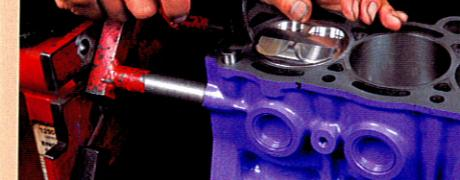
シリンダーブロックの端部にノックピングを打ち込む。言わなくても分かると思うが、シリンダーヘッドの位置決め用だ
