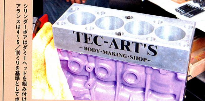
シリンドラーボアはダミーヘッドを組み付けてクリアランスを計測していく。この時点では計測する必要はないが、念のため基本は4.5/100ミリ
