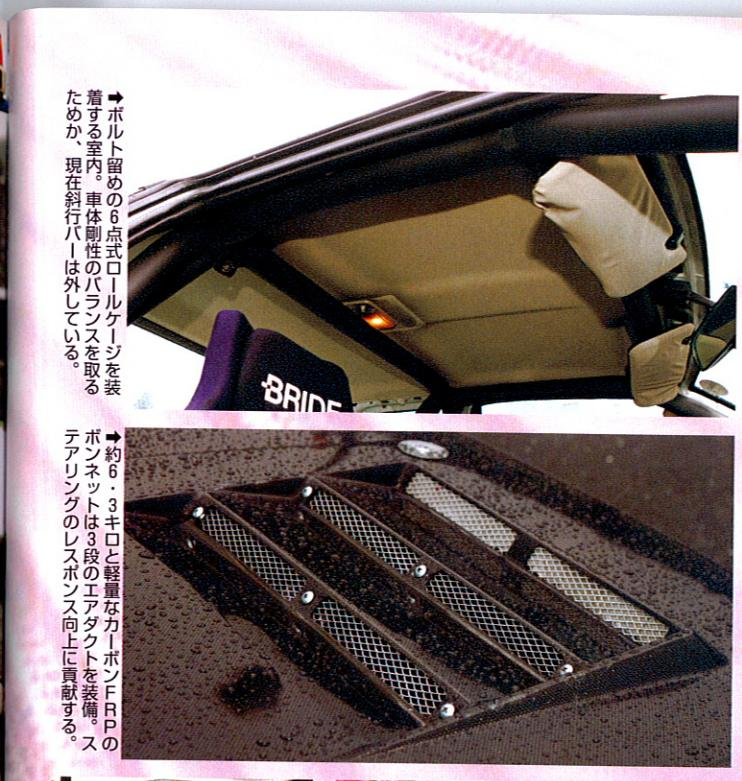
→ボルト留めの6点式ロールケージを装着する。室内の車体剛性のバランスを取るためか、現在斜行バーは外している。
