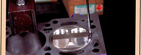
23 面研やガスケットの関係、圧縮比との兼ね合いもありピストン突き出し量を計測する。ダイヤルゲージをブロックに載せ、突き出し量を計測。突き出し量は0.05~0.08ミリだ
