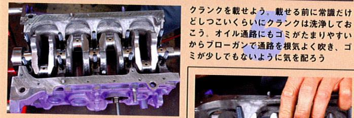
クランクを載せよう。載せる前に常識だけしつこいくらいにクランクは洗浄しておこう。オイル通路にもゴミがたまりやすいからプローチングで通路を根気よく吹き、ゴミが少しでもないように気を配ろう
