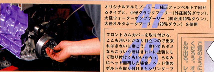
フロントカムカバーを取り付ける。ここも汚いとかなり目立つので出来ればきれいに磨こう。磨いてもダメならこういう所はきれいに塗装にして取り付けてもいいだろう。ちなみにヘッド面研した場合、ヘッド側のボルトを取り付けるとシリンドラーブロックのネジはずれていてつかない
