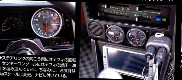
↑ステアリングの向こう側にはデフィの回転計、センターコンソールにはデフィの燃圧・油圧計を埋め込んでいる。ちなみに、速度計は240kmスケールに変更している。ナビも付いている。
