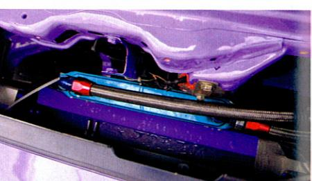
↑ラジエターとフロントグリルの間に装着されるオイルクーラー。ちなみにラジエターはCA18純正を使用する。
