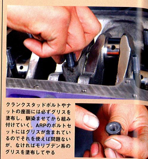
クランクスタッドボルトやナットの座面には必ずグリスを塗布し、刷染させてから組み付けていく。ARPのボルトセットにはグリスが含まれているのでそれを使えば問題ないが、なければモリブデン系のグリスを塗布してやる
