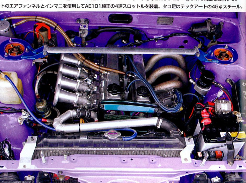
↓テックアートのエアファンネルとインマニを使用してAE101純正の4連スロットルを装着。タコ足はテックアートの45φスチール。
