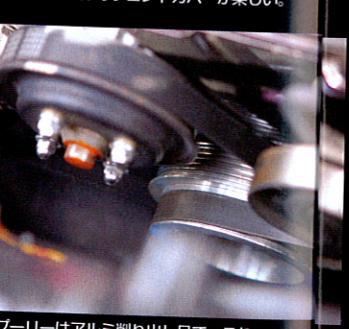
↑ブリーはアルミ削り出し品で、これもテックアートオリジナル。ラジエーターの冷却ファンは電動式に変更している。
