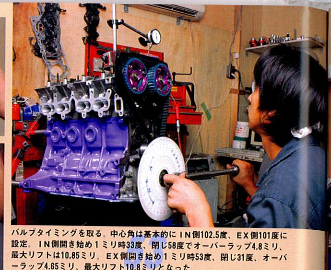
バルブタイミングを取り。中心角は基本的にIN側102.5度、EX側101度に設定。IN側開き始め1ミリ時33度、閉じ58度オーバーラップ4.8ミリ、最大リフトは10.85ミリ。EX側開き始め1ミリ時53度、閉じ31度、オーバーラップ4.85ミリ、最大リフト10.8ミリとなった
