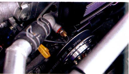
↑アルミ製大型ウォーターボンブフリーを組み込み、高回転での回転数を調整。伝達ロスも最小限に押さえる。
