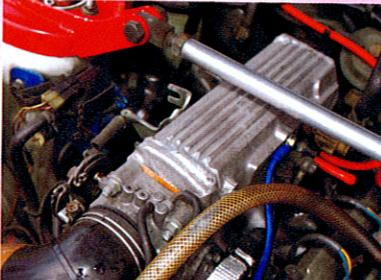
↑吸気は92のシングルスロットルを使用して、パワーFCで細かく混合気を制御する。
