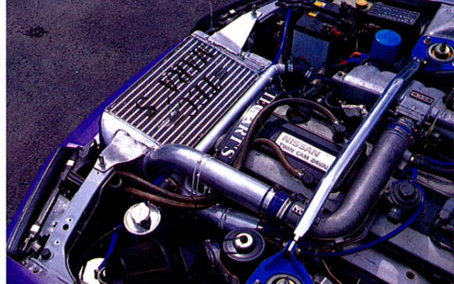
パイピングはワンオフ。いかに太く短くなったか、スカイラインオーナーなら一目瞭然だよな。これがシャープな吹けあがり貢献するんだ。ラジエターは車種不明のアルミ3層タイプで、配管をワンオフして傾けてマウントしている関係上、クーラントからエアが抜けにくくなる。セパレーター(キャップがついたアルミの筒)は絶対に必要だ。
